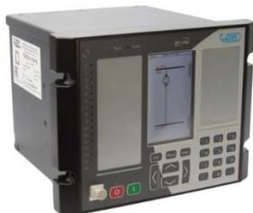
Все короткие замыкания в электросети распознаются специальными устройствами - релейной защитой (РЗ). **Устройства РЗ устанавливаются почти на каждом выключателе**, образуя систему релейной защиты всей электросети (более 1 млн. шт. только в РФ).
